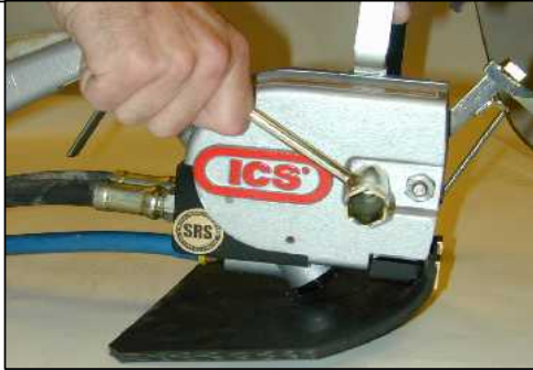
VAIHE 1: Irrota suojan kiinnitysmutterit ja poista sivusuoja.
